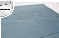
**Scié fin et brossé:** Le bois refendu à la scie à ruban présente une surface brute de sciage. Par un procédé de brossage répété et minutieux, les fibres de bois détachées sont partiellement éliminées pour garantir une qualité optimale de la surface des profilés, cela afin d'offrir le meilleur support à toute finition.
