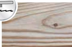
**Surface brossée:** La surface préalablement rabotée est travaillée de manière intensive à l'aide de brosses. Les bois tendres comme l'épicéa possèdent des cernes de croissance tendres et durs qui se creusent en fonction de la dureté du bois lors du brossage, on obtient une surface « ondulée » accentuant bien la structure du bois.
